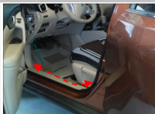
3.4 布撑杆正极线 拆卸原车驾驶室 A 柱内侧装饰件；(虚线)
