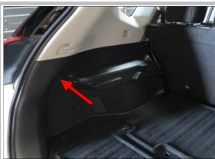
3.11 接负极：负极接线位置在尾箱左侧看到不带油漆的螺栓柱，装上连接片，卡紧后再还原拧紧螺母；
