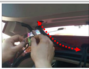
3.3 把正极、负极线、驱动盒线束穿过波纹管，延伸到尾箱左侧；
