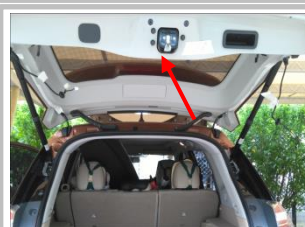
3.22 接门锁线：在尾门上方，箭头位置找到原车信号线插头；注意如图拍摄角度；
