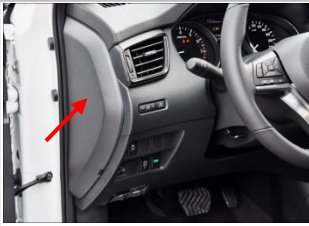
3.15 解码器负极：在主驾驶室此盖板拆下后看见原车螺栓柱
