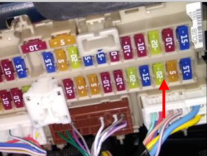
3.9 接正极：看到原车保险盒，取下此 20A 保险丝安装在我司取电器上，再把取电器复位；
