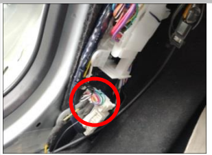
3.18 接 CAN 线：CAN 线接线如下图所示，在主驾驶 A 柱内饰
