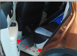
3.5 布撑杆正极线 拆卸左侧迎宾踏板胶条；线束穿过后门迎宾踏板胶条；
