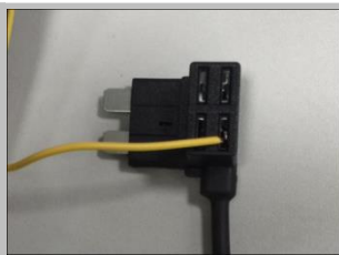
3.14 拆下保险丝，把黄色线铜丝如图插入保险丝取电器内；
