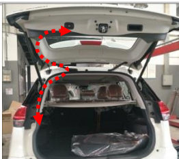
3.1 ECU 上置，蜂鸣器、左右撑杆线束上置；
