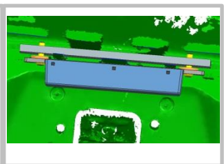
4.12 用 ECU 配合滑槽夹紧原车钣金，用两颗内六角平原头螺钉 M6 20、平垫圈 D10 平行拧紧固定好，防止松动脱落；
