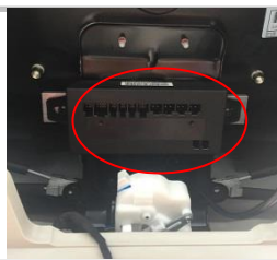
4.11 安装 ECU :ECU 安装在尾门盖板上门锁圆圈处位置，图片为尾门打开状态；
