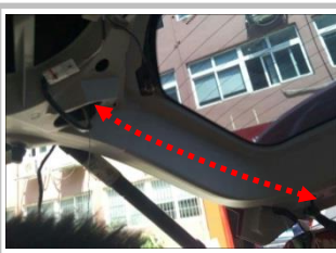
3.2 正极、负极线束、驱动盒线束穿过内侧，通过波纹管延伸到尾箱下；
