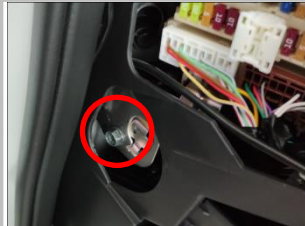
3.16 解码器负极：松动螺母，卡进负极连接片，卡紧后再还原拧紧螺母，
