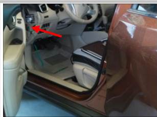
3.7 接正极：在驾驶室中控台左侧箭头位置拆下面板；
