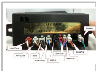
4.10 连接 ECU，待所有线束插好，最后插电源线插头；（插头如前面 ECU 插头说明示意图）
