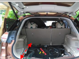
3.6 布撑杆正极线 穿过后门迎宾踏板胶条内侧延伸至尾箱预留合适线束连接；
