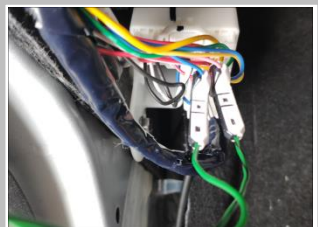
3.20 其中粉色为 CAN_L 接我司的绿黑色线，蓝色为 CAN_H 接我司的绿色线
